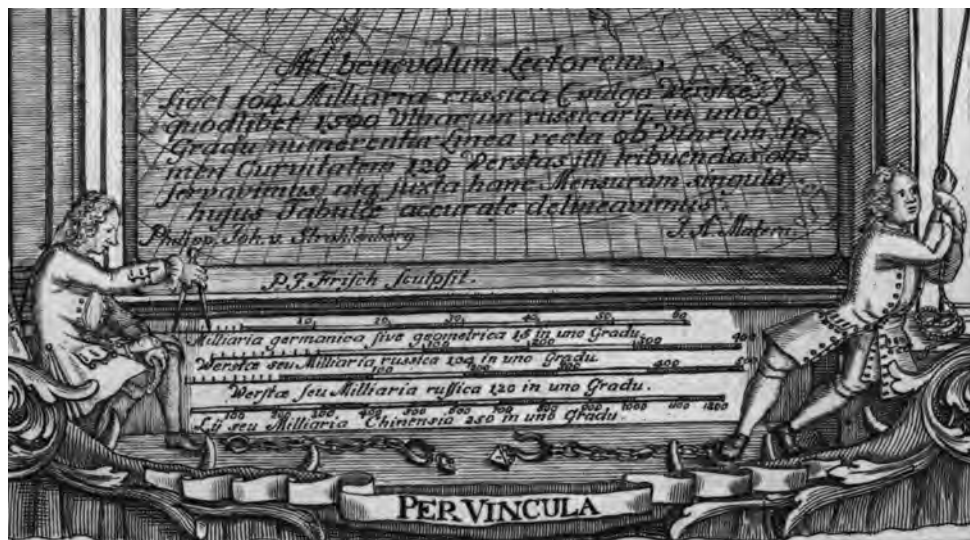
Рис. 7. Фрагмент картуша на гравированной карте Ф. И. фон Страленберга и И. А. Магтерна «Nova descriptio geographica Tattariae Magnae...», изданной в 1730 г. Указан размер градуса меридиана на четырех линейках: «Миль германских, или геометрических, 15 в одном градусе», «Верст, или миль русских, 104 в одном градусе», «Верст, или миль русских, 120 в одном градусе», «Ли, или миль китайских, 250 в одном градусе»
