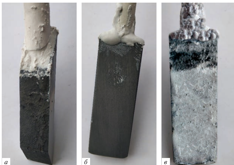
Рис. 1. Внешний вид анода и катода до электролиза: а – металлический анод, б – графитовый катод до борирования, в – графитовый катод после борирования.
