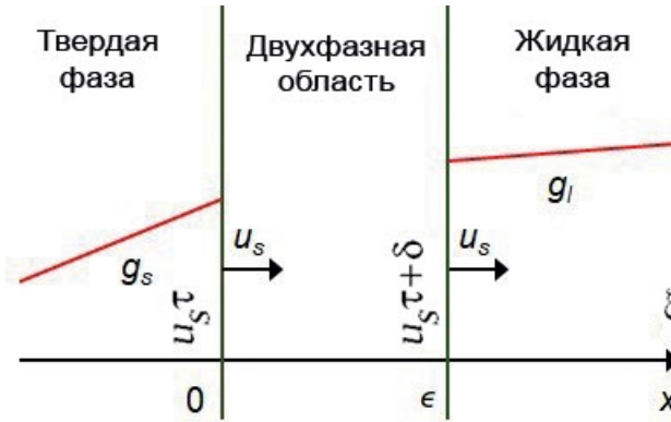
Рис. 1. Схема процесса направленной кристаллизации с областью фазового превращения, которая движется вдоль пространственной оси \xi с постоянной скоростью u_s .
