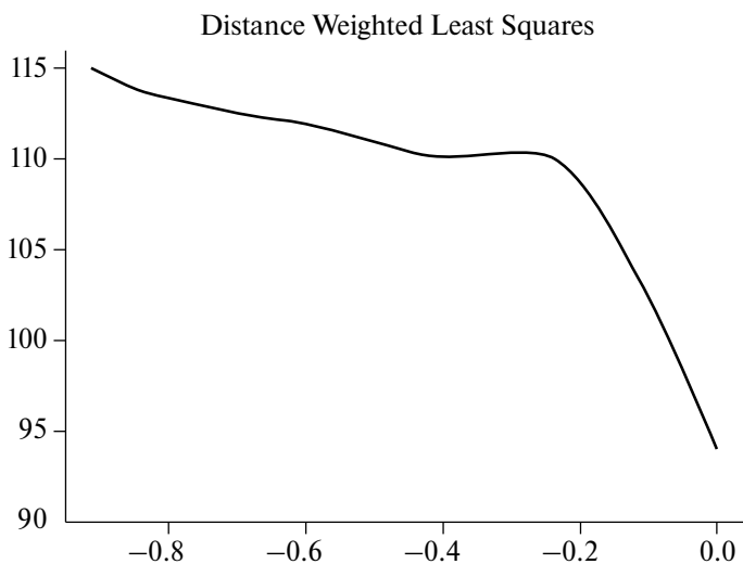
Рис. 4. Зависимость твердости порошкового материала 12X18H10T от высотной деформации.
