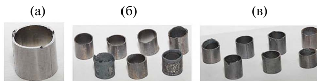
Рис. 1. Внешний вид образцов: а) до испытаний, б) после выдержки 12 часов при температуре 650°C в атмосфере азота, в) после выдержки 12 часов при температуре 800°C в атмосфере азота.
