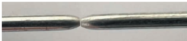
Рис. 3. Вид шейки образца на растяжение перед разрушением.
