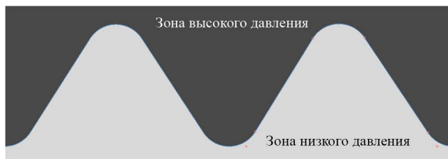
Рис. 4. Развертка поверхности втулки ЭДЭ с разделением зон высокого и низкого давления в узле осевой разгрузки.
