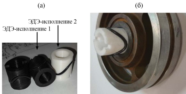
Рис. 3. Защитные втулки с эластичным демпфирующим элементом – ЭДЭ радиального подшипника узла осевой разгрузки ротора ЛВН 01-92: (а) – втулки с исполнением 1 и 2; (б) – вид установки втулки в подшипник.
