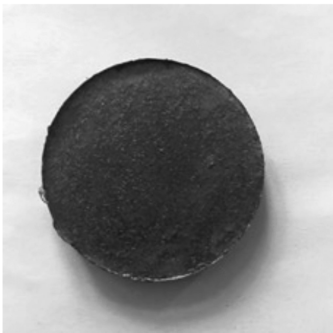
Рис. 1. Внешний вид спеченного образца из материала \text{BrO10C10} .
