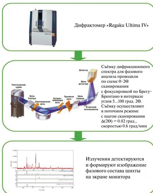
Рис. 3. Блок-схема методики исследования фазового состава.
