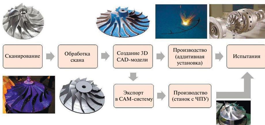
Рис. 1. Процесс реверс-инжиниринга для получения физического объекта [3].
