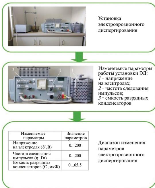
Рис. 2. Блок-схема регулировки режимов работы установки.
