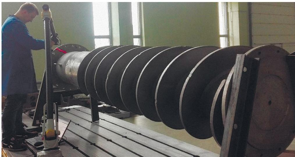
Рис. 3. Процесс сканирования пространственной геометрии шнекового вала с помощью лазерного сканера ModelMaker MMD×100.
