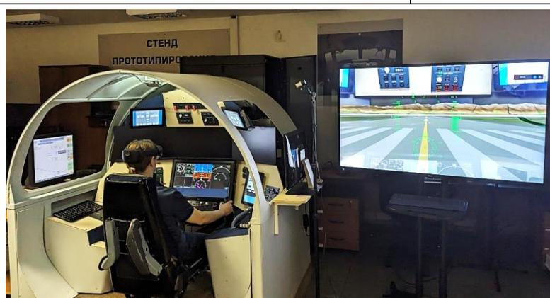
Рис. 3. Демонстратор ИУП кабины воздушного судна гражданской авиации с наголовной индикацией
