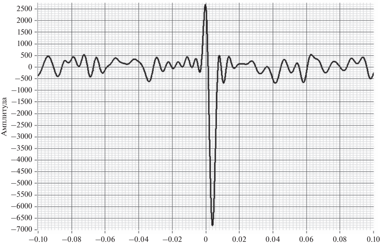
Рис. 2. Инверсия взаимно-корреляционной функции при обработке “фазовых” сигналов.
