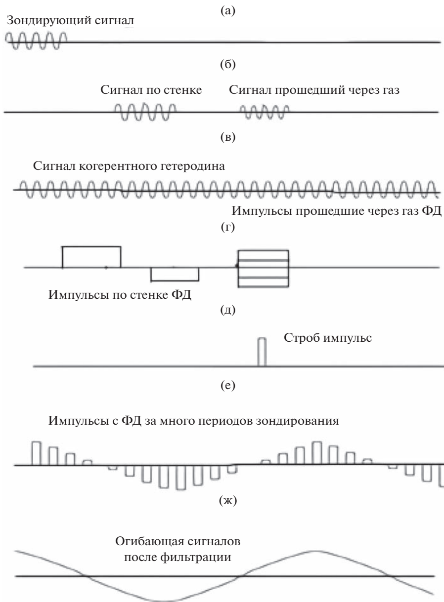
Рис. 3. Осциллограммы сигналов в импульсно-когерентном расходомере. (а) — Зондирующий сигнал, (б) — сигналы, принятые приемником, (в) — сигнал когерентного гетеродина, (г) — импульсы с фазового детектора сигналов, прошедших по стенке и через газ, (д) — строб-импульс, (е) — сигналы, запомненные в УВХ за несколько периодов, (ж) — огибающая сигнала после детектирования.
