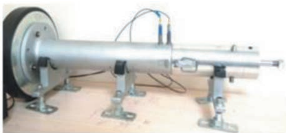
Рис. 6. Укомплектованный и готовый к работе интерферометр.
