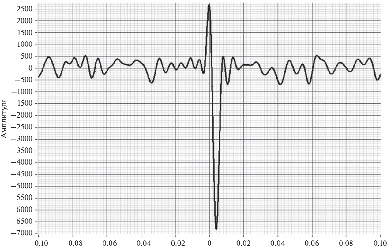
Рис. 2. Инверсия взаимно-корреляционной функции при обработке “фазовых” сигналов.
