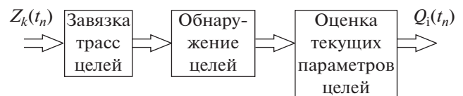
Рис. 13. Блок-схема вторичной обработки информации, Q_i(t_n) – формуляры обнаруженных целей, содержащие их текущие параметры – координаты и скорость движения цели.
