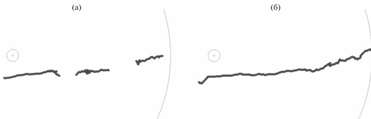
Рис. 14. Результаты обнаружения и оценки координат от движущегося отражателя в натурном эксперименте, полученные на выходе алгоритмов (а) — обнаружения одиночных импульсов и (б) — с квазиоптимальным накоплением.
