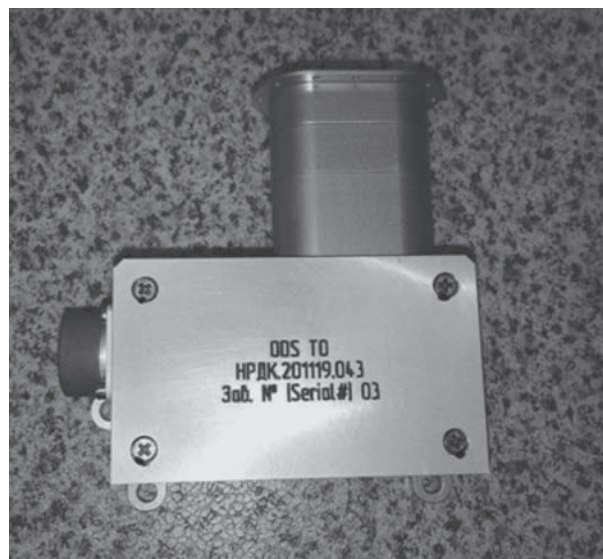
Рис. 1. Общий вид прибора ODS. В верхней части размещен оптический тракт, в нижней – плата электроники.
