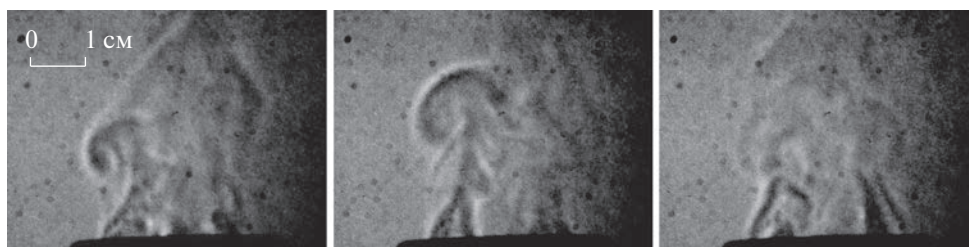
Рис. 5. Эволюция крупномасштабной вихревой структуры в плазменной струе (последовательность кадров видеосъемки с частотой 24 кадр/с, время экспозиции \approx 0.7 мс).
