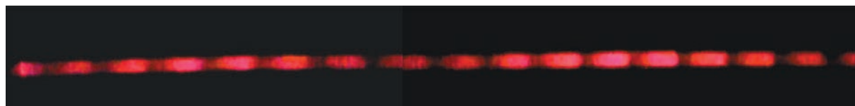
Рис. 8. Фото разряда, поддерживаемого стоячей ПЭВ ( p = 9 Торр). Расстояние между зеркалами L = 84 см.
