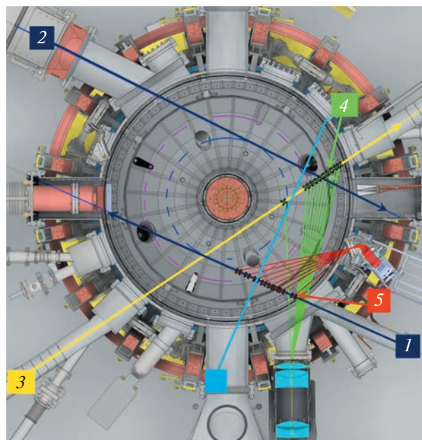
Рис. 1. Экваториальное сечение токамака Глобус-М2: 1 — линия инжекции НИ-1; 2 — линия инжекции НИ-2; 3 — зондирующий луч диагностики томсоновского рассеяния; 4 — хорды наблюдения диагностики томсоновского рассеяния; 5 — хорды наблюдения диагностики активной спектроскопии перезарядки CXRS; 6 — линия наблюдения анализатора атомов перезарядки АКОРД-24М. Синей штриховой линией обозначен прицельный радиус инжекторов, а фиолетовой штриховой линией — положение магнитной оси.
