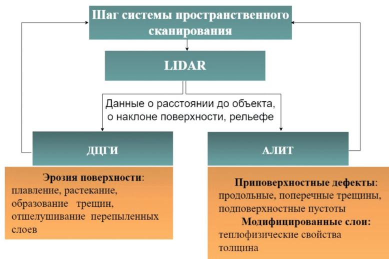
Рис. 3. Блок-схема диагностического комплекса.
