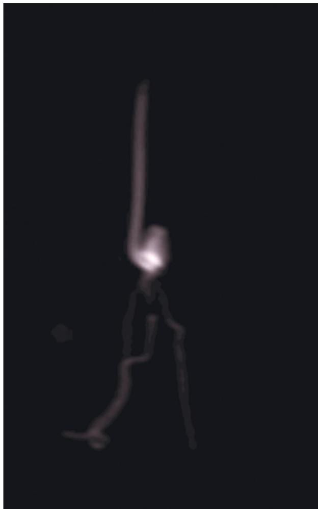
Рис. 1. Изображение проростка, корня и зерна пшеницы, полученное с помощью разработанного датчика с диаметром 19 мм методом  $T_1$  взвешенного изображения.
