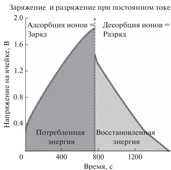
Рис. 41. Схематическое изображение изменения во времени напряжения на стадии заряда и на стадии разряда [373].
