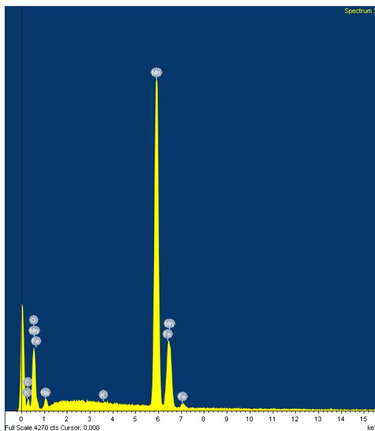
Рис. S1. Пример спектра РСМА для образца, осажденного из раствора 20 мМ  $\text{KMnO}_4$  + 0.3 мМ  $\text{K}_2\text{FeO}_4$ .
