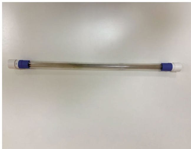
Рис. 1. Внешний вид изготовленного мембранного модуля на основе никелевых капилляров.
