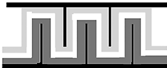
Рис. 2. 3D-конструкция с встречно-штыревыми массивами электродов.
