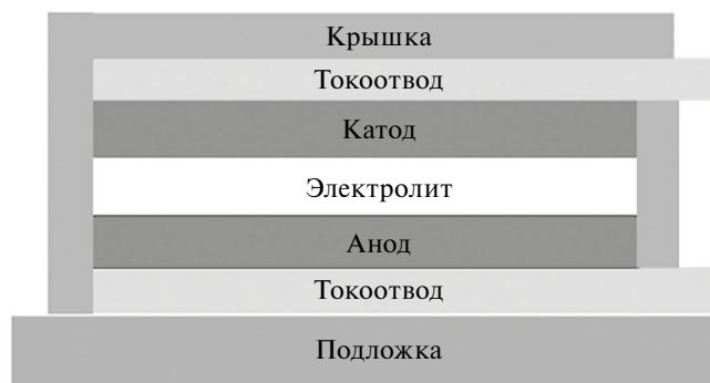
Рис. 1. Схема полностью твердотельного тонкопленочного литий-ионного аккумулятора.
