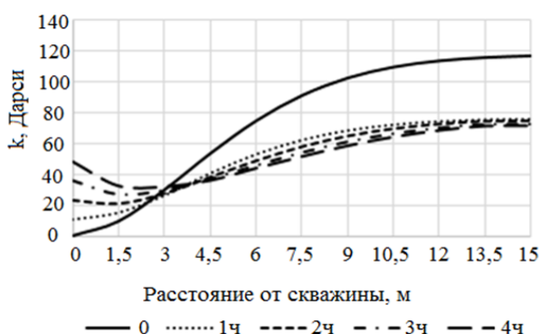
Рис. 5. Изменение абсолютной проницаемости k(x,t) за 4 часа виброимпульсного воздействия
