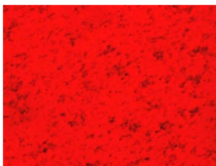
Рис. 2. Результаты визуального IDE-теста выпадения асфальтенов с концентрацией углекислоты 39,920\% моль при температуре 58,0^\circ\text{C} :
