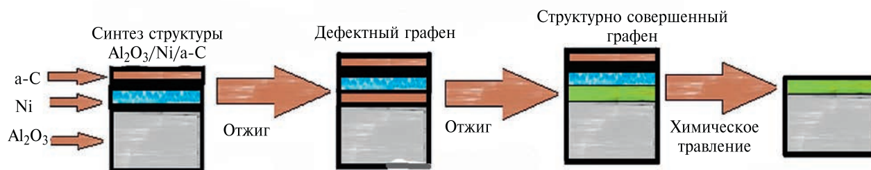
Рис. 2. Схема получения графена методом отжига.
