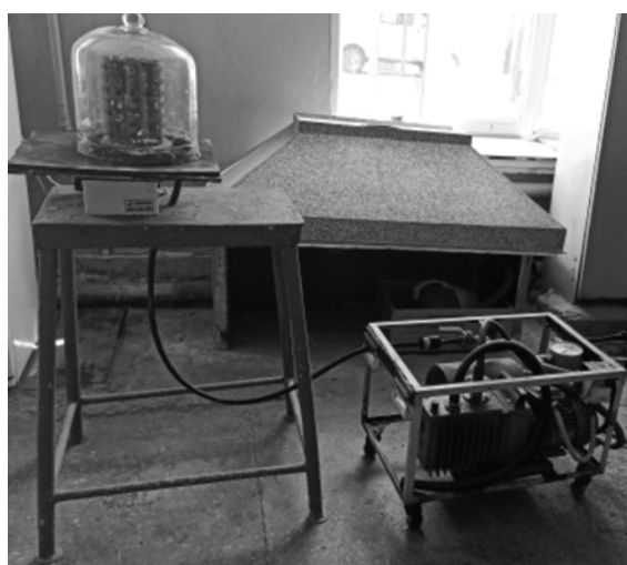
Фиг. 2. Установка для вибровакuumной пропитки алюминиевым расплавом углеграфитового образца с гальваническим покрытием
