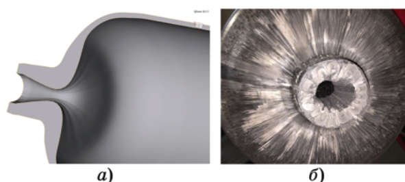
Фиг. 8. Лейнер, полученный по найденным искусственным интеллектом параметрам: а — результаты моделирования в программе QForm; б — опытное изготовление лейнера
