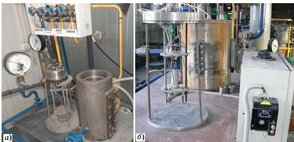
Фиг. 1. Лабораторные СВС-реакторы: а — объемом 3 дм<sup>3</sup> (БПД-3); б — 15 дм<sup>3</sup> (БПД-15)
