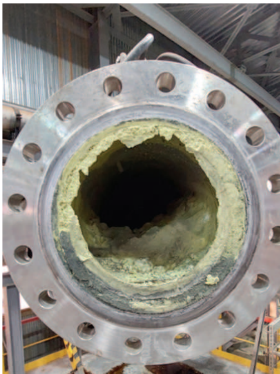
Фиг. 1. Отложения элементарной серы в газоходе
