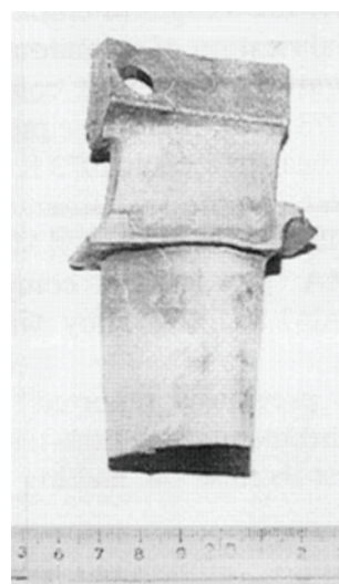
Фиг. 4. Лопатка турбины, полученная методом ГИП сферического порошка \text{Nb}_3\text{Al} , легированного молибденом [91]
