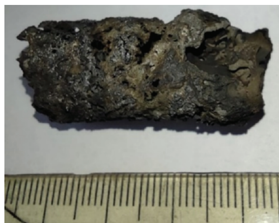
Фиг. 3. Внешний вид образца азотированного железа
