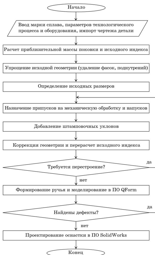
Фиг. 2. Схема общего алгоритма для проектирования поковки
