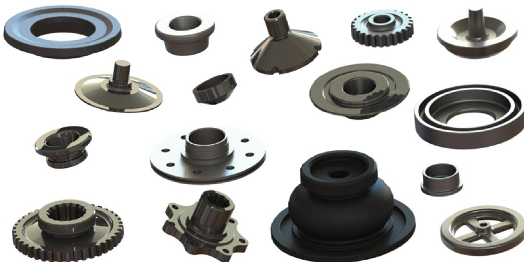
Фиг. 1. Примеры осесимметричных деталей и поковок
