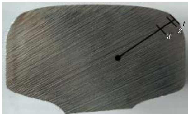
Фиг. 1. Образец рельса после пропущенного тоннажа 187 млн. т и схема, объясняющая приготовление объектов исследования 1—3 (соответственно образцы поверхностного металла и слоев на расстоянии 2 и 10 мм от поверхности по радиусу скругления выкружки)
