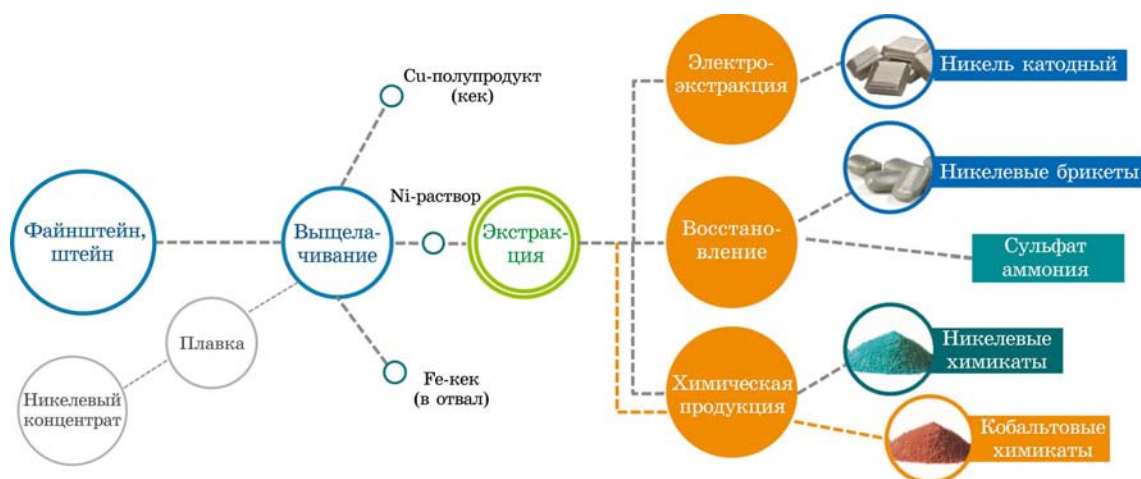
Фиг. 1. Принципиальная блок-схема предприятия «Norilsk Nickel Harjavalta Oy» (NNH)
