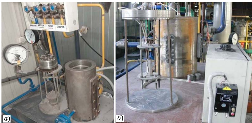
Фиг. 1. Лабораторные СВС-реакторы: а — объемом 3 дм 3 (БПД-3); б — 15 дм 3 (БПД-15)
