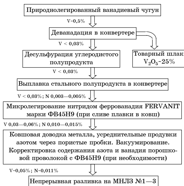
Фиг. 6. Технологическая схема выплавки рельсовой стали К76ХФ дуплекс-процессом в конвертерном цехе АО «ЕВРАЗ-НТМК»
