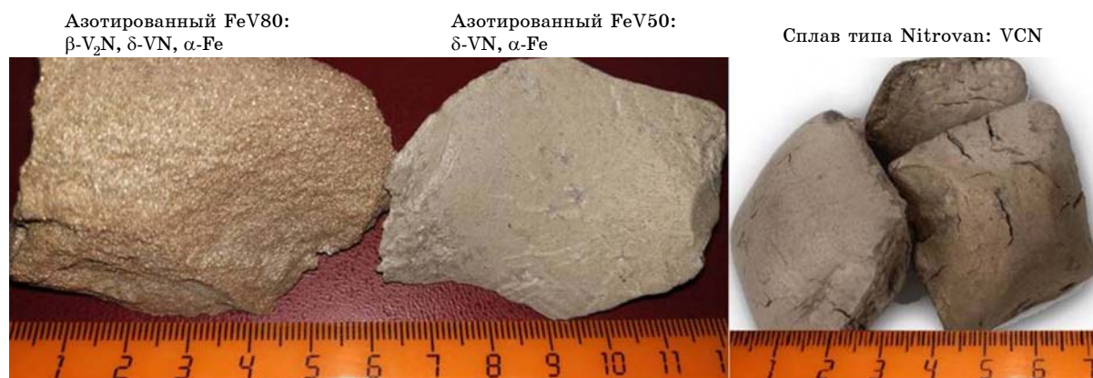
Фиг. 5. Макроструктура и фазовый состав СВС-нитрида феррованадия и сплава типа Nitrovan
