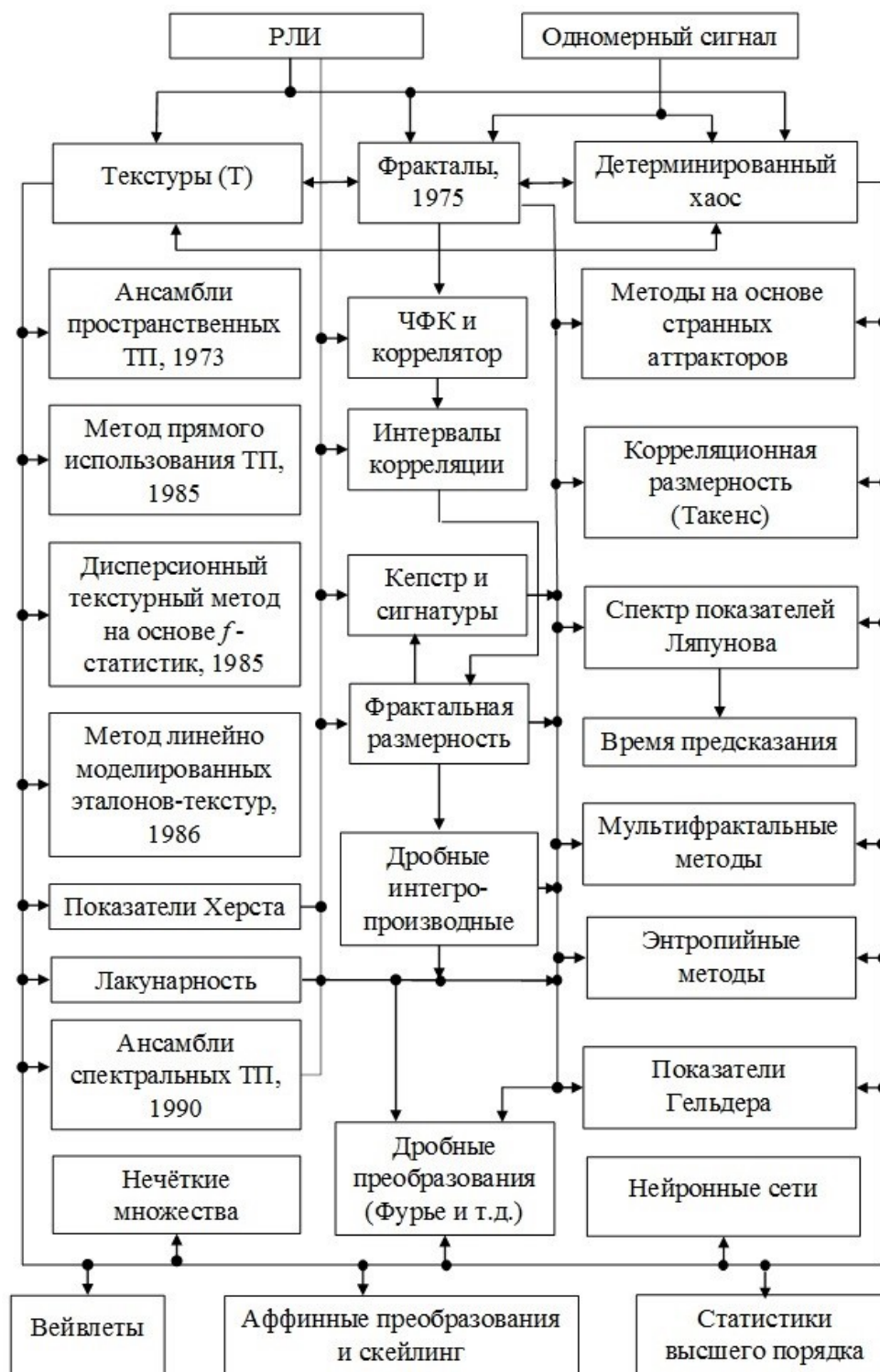
Рис. 5. Новые топологические признаки и методы обнаружения малококонтрастных (малозаметных) объектов на фоне интенсивных шумов и помех (ТП — текстурные признаки, ЧФК — частотная функция когерентности)
