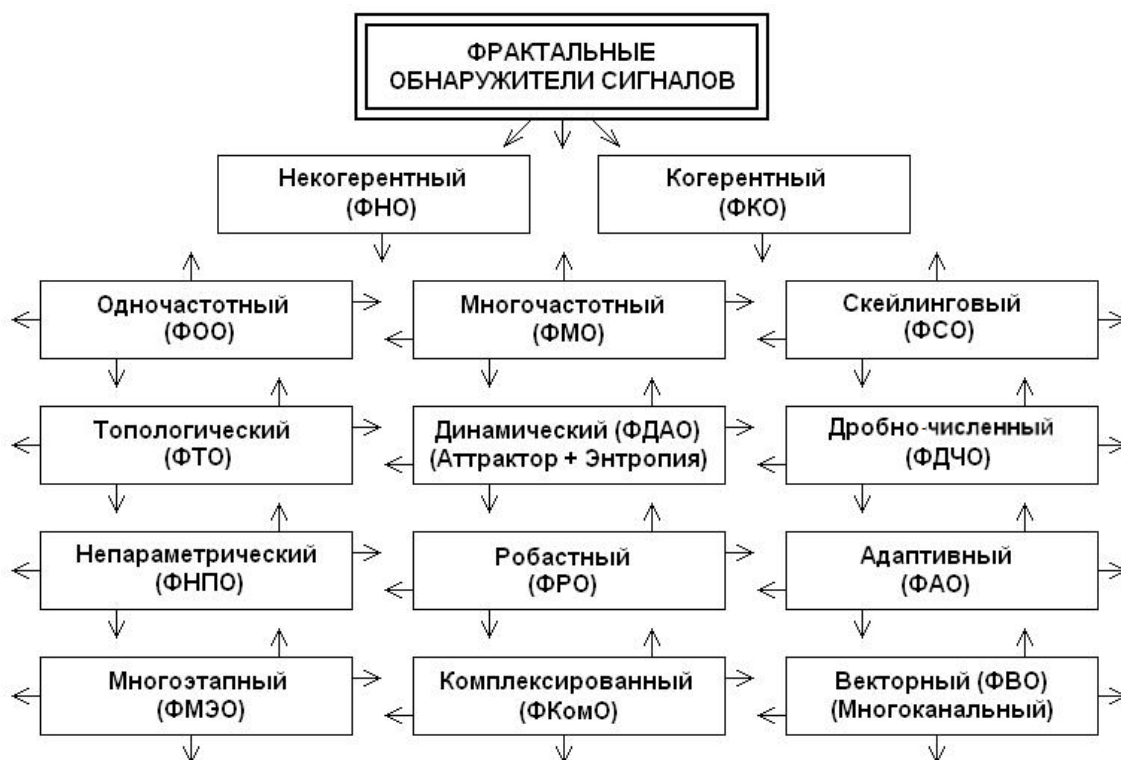
Рис. 7. Основные виды предложенных топологических фрактально-скейлинговых обнаружителей многомерных сигналов
