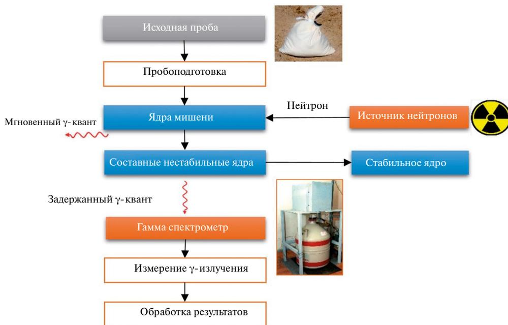
Рис. 1. Принципиальная схема метода ИНАА
