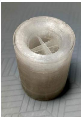
Рис. 2. Внешний вид лопаточного завихрителя.
