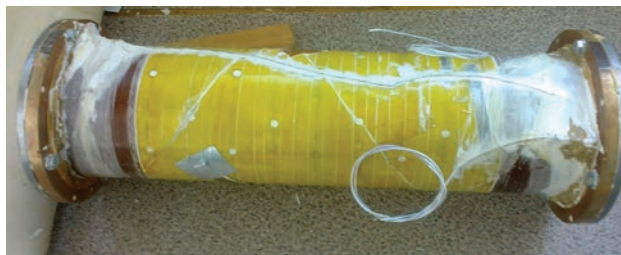
Рис. 2. Соленоид после пропитки эпоксидным компаундом.
