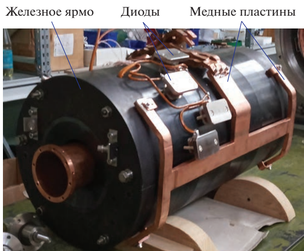
Рис. 3. Сборка соленоида перед установкой в собственный криостат.
