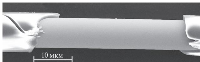
Рис. 2. РЭМ-изображение микропровода состава  $\text{Fe}_{73.9}\text{B}_{13.2}\text{Si}_{10.9}\text{C}_2$ .
