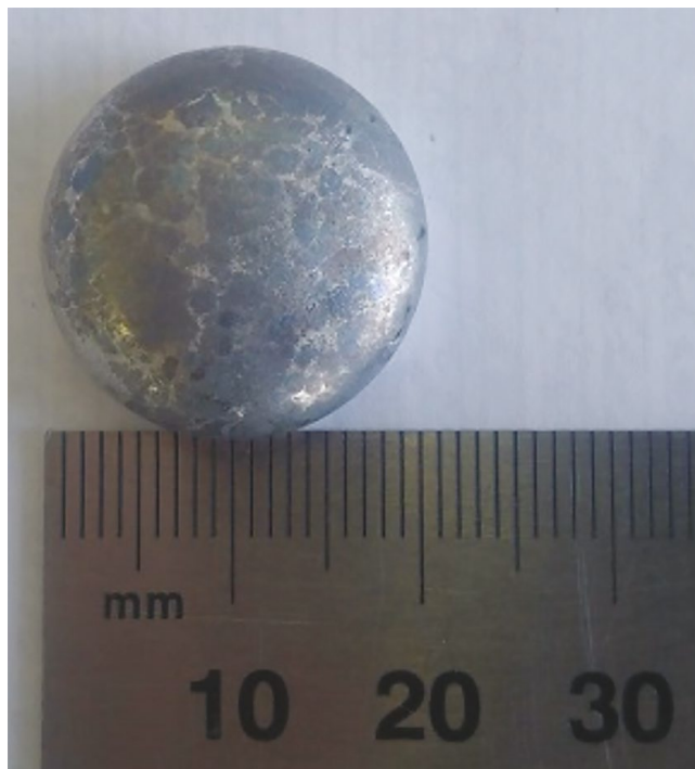
Рис. 1. Исходный слиток AlNiCoFeCr, полученный методом дуговой плавки.
