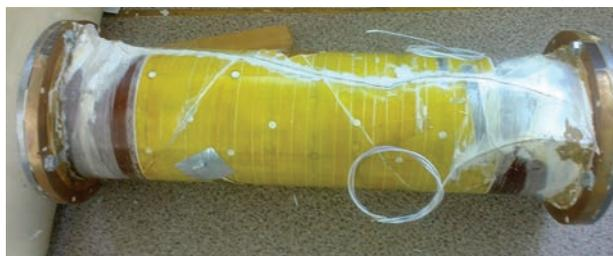
Рис. 2. Соленоид после пропитки эпоксидным компаундом.
