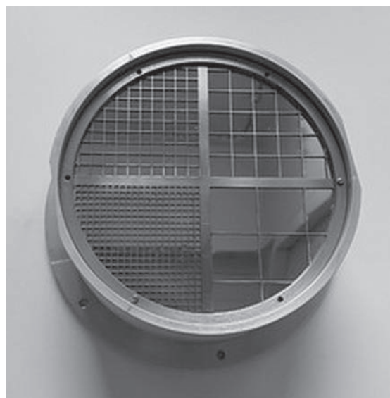
Рис. 5. Макет фильтра для акустических испытаний с ячейкой поддерживающей сетки разных размеров (2.5, 5, 10 и 20 мм).
