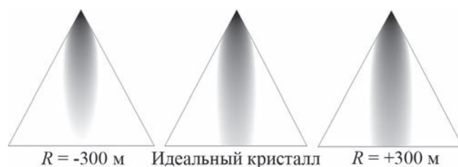
Рис. 5. Численное моделирование волнового поля в треугольнике рассеяния в случае толстого кристалла при разных знаках изгиба отражающих плоскостей.
