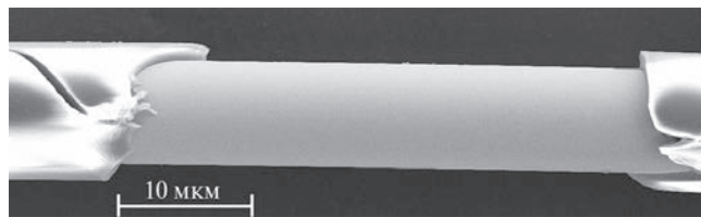
Рис. 2. РЭМ-изображение микропровода состава \text{Fe}_{73.9}\text{B}_{13.2}\text{Si}_{10.9}\text{C}_2 .
