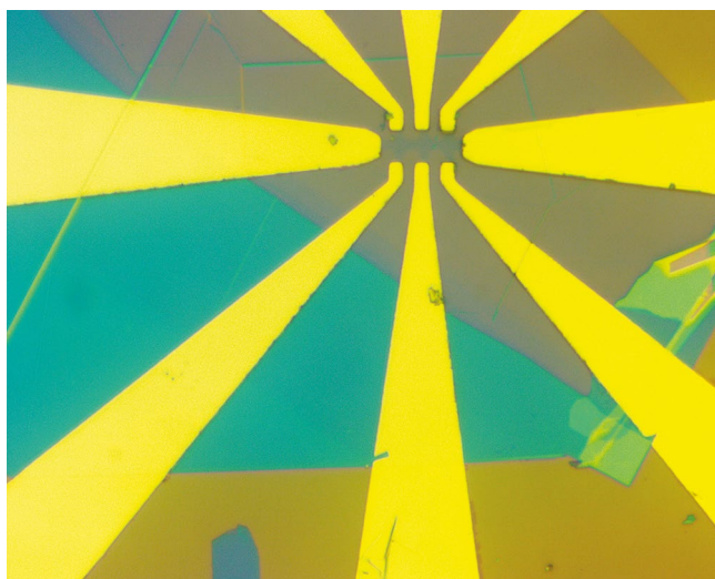
Рис. 4. Оптическое изображение мостика Холла образца h-BN/Gn. Размер подложки составляет 1 \times 1 \text{ см} .
