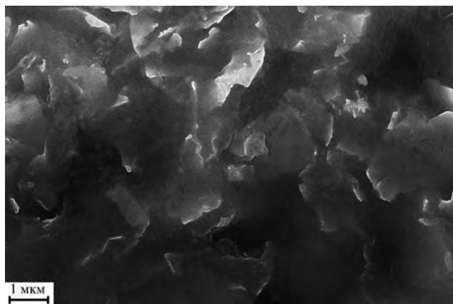
Рис. 5. РЭМ-изображение поверхности образца пленки Ф-42, наполненного 5 мас. % наногрфита.
