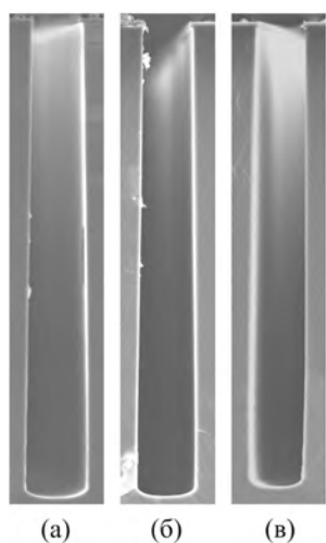
Рис. 6. Профили травления канавок при разных параметрах R – \Delta : 0.3–1.6 с (а), 0.27–1.1 с (б), 0.23–0.6 с (в).
