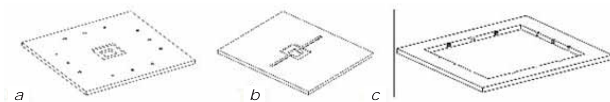
Рис. 2. Изображение первого (а), второго (b) и третьего (с) слоев микрофлюидной ячейки составного типа.
