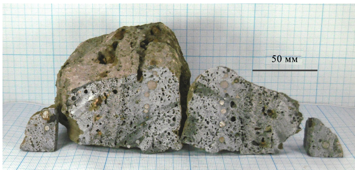
Рис. 1. Собранные в районе падения ЧКТ фрагменты со следами доменного процесса.
